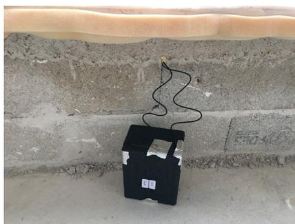
Sonde à cœur d'une maçonnerie en pied de paroi.
